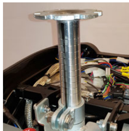
Justera in sätesstolpen till önskat läge. Sätesstolpen är markerad med en ring för varje centimeter.
