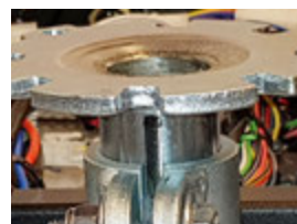
Var uppmärksam på att den svarta linjen skall vara på samma ställe efter justeringen som innan, så sätet inte sitter snett.
