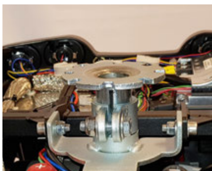
Var uppmärksam på att den svarta linjen skall vara på samma ställe efter justeringen som innan, så sätet inte sitter snett.
