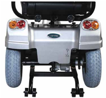
Leveä akseli ja isot pyörät sekä kaatumisesteet takaavat vakaan ja tasaisen ajon. Huom. Kuvassa eri kaatumisesteet
