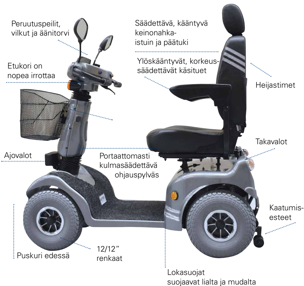
Kulmasäädettävä ohjauspylväs ja kääntyvä istuin
