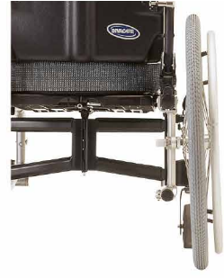
2° camber Kulmasäädetyt kelauspyörät saavat tuolin kulkemaan paremmin suorassa.
