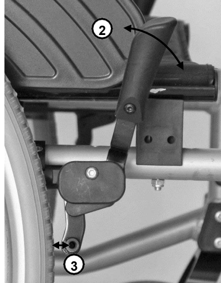
Jarru pois päältä (pyörätuoli liikkuu)
