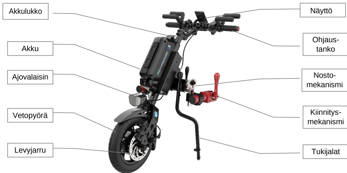
Kuva 1. Laitteen pääosat (esimerkkikuvassa manuaalinen kiinnitys- ja nostoratkaisu).
