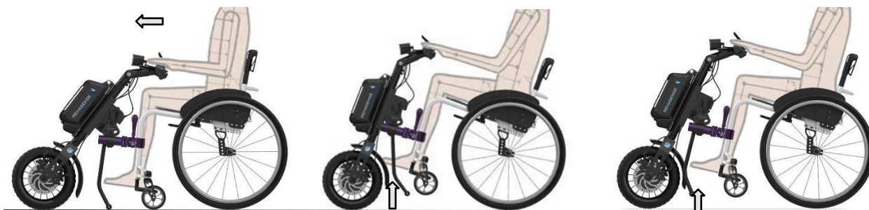
Kuva 35. Manuaalisella kiinnitys- ja nostomekanismilla varustettujen laitteiden asennot: pysäköinti (1), kaupunkiajo (3) ja retkiajo (2).
