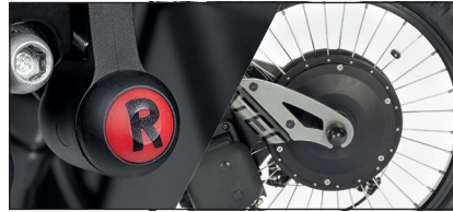
250 RPM 900W korkean vääntömomentin hiiliharjaton moottori + peruutusvaihte. Max. 25 Km/h.
