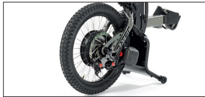
18" ultra-grip rengas ja alumiini-double-wall vanne
