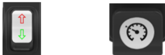
Kuva 27. Kytkimet ja merkkivalot Suunta; Vakionopeudensäädin;
