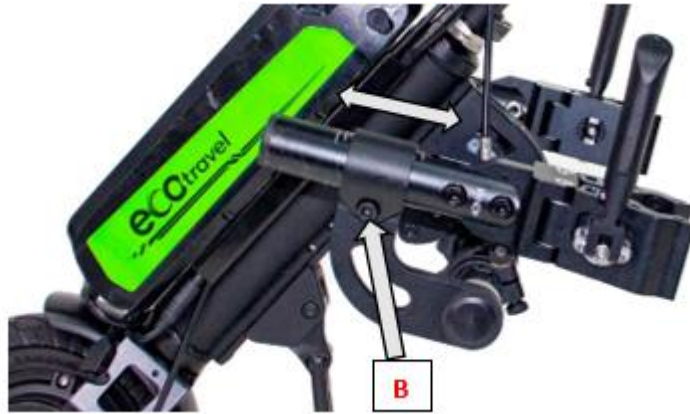
Kuva 22. Kiinnitysmekanismin syvyyden säätäminen suhteessa laitteeseen
