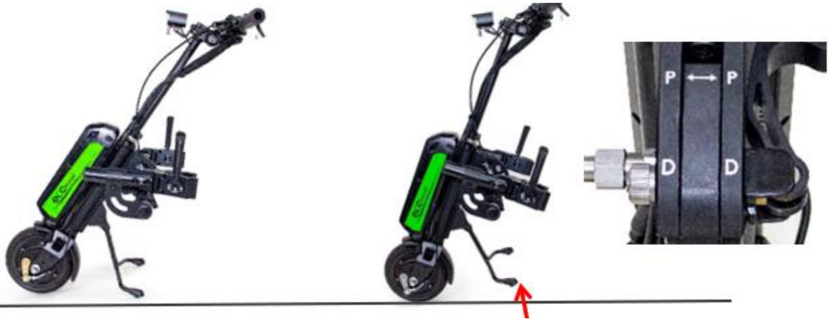
Kuva 25. Manuaalisten kiinnitys/nostolaitteiden pysäköinti- (P) (1) ja ajoasennot (D) (2)
