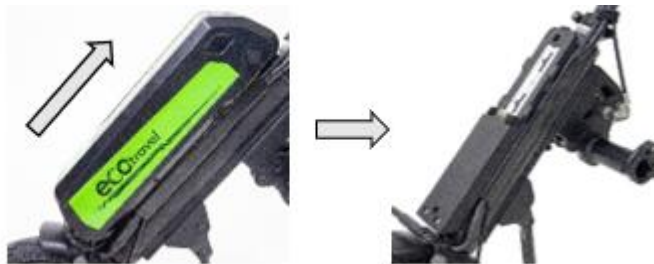
Kuva 29. Akun poistaminen ja vaihtaminen
