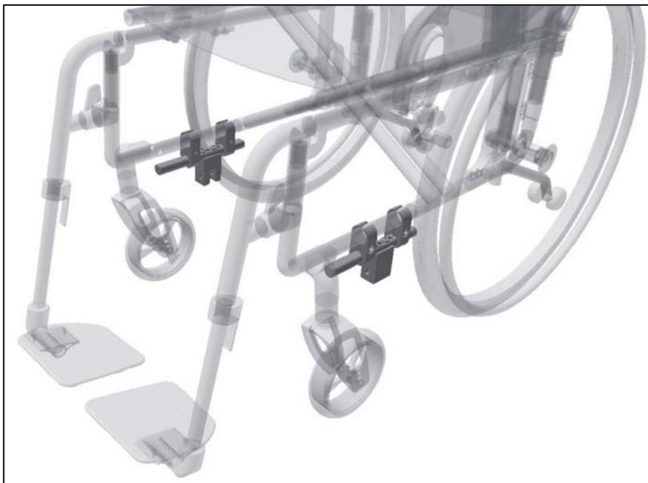
Kuva 7, Liitintangon kiinnitys pidikkeisiin pikalukitustapeilla
