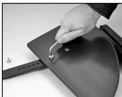
Kuva 31 Irrota liikusäätimen sivut
