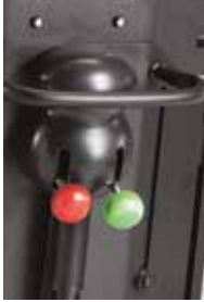
Lukitus / avausjärjestelmä sis. turvapainike, jotta istuin ei irtoa vahingossa rungosta
