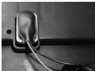
9 V:s backupbatteri för nödlägesänkning
