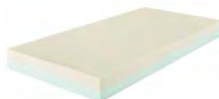
6 cm viskoelastinen kerros (75 kg/m 3 / 1.8 kPa) ja 8 cm (28 g/m 3 / 3.6 kPa) vaahtomuovi
